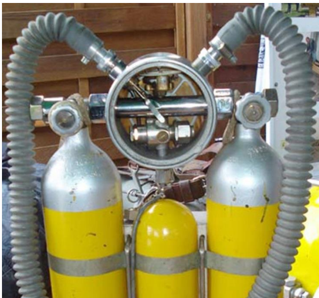
Otevřená automatika potápěčského přístroje KP-4 Josefa Voříška (P. Katz)
