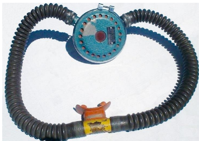
Kompletní jednostupňová automatika AV1 (archiv L. Seveke)
