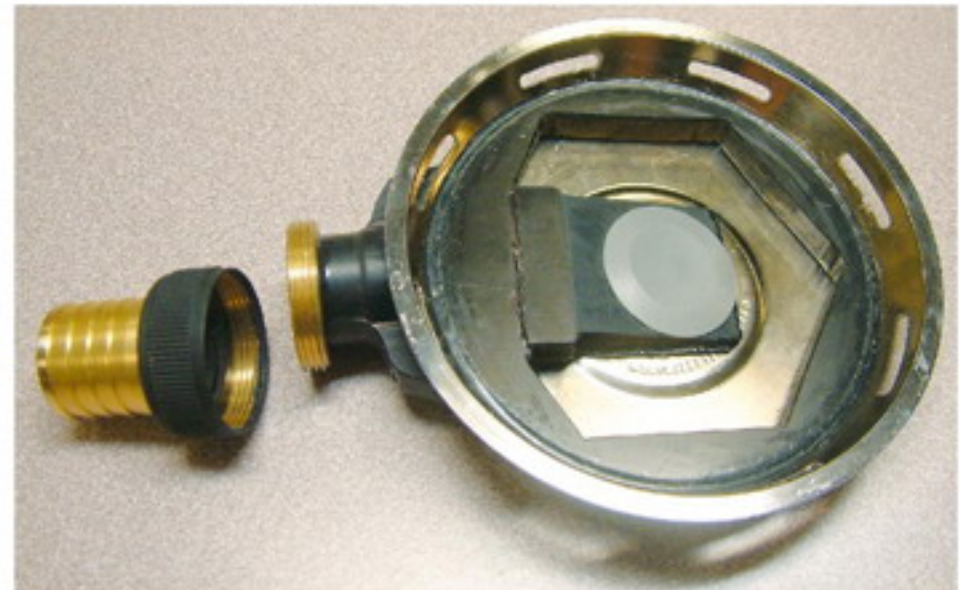
Modifizierte Regler-Oberschale des Saturn
