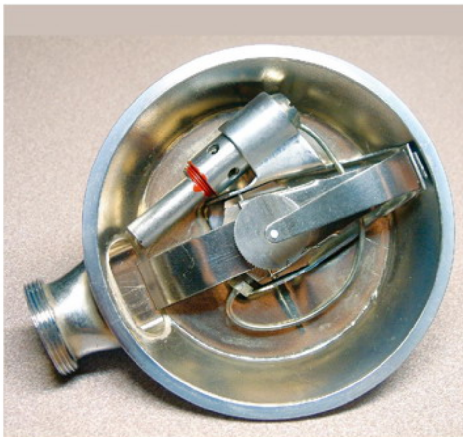
Geöffneter Atemregler Saturn mit Warnpfeife
