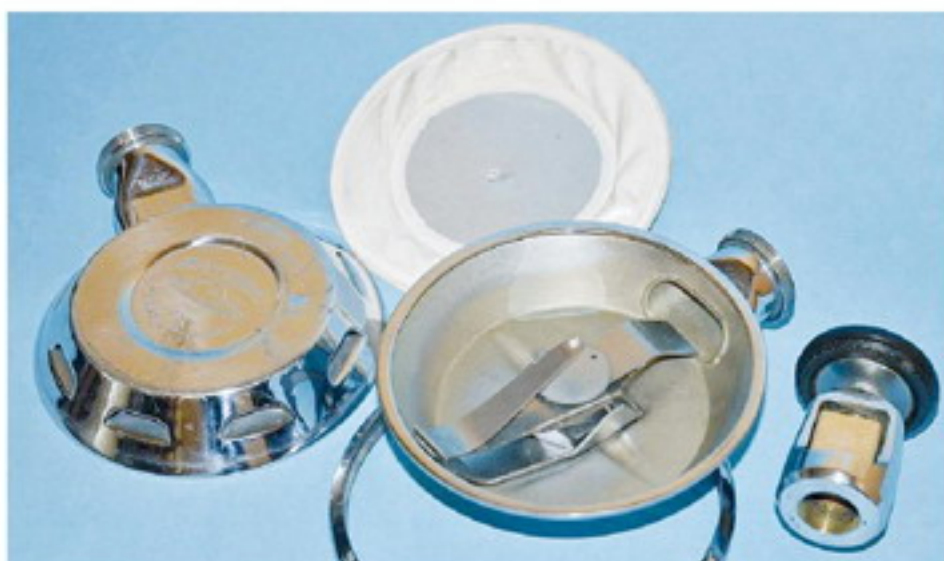
Geöffneter Tauchregler Saturn
