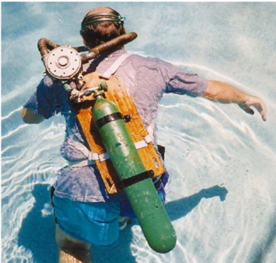
Rustikale Eigenbaukonstruktion mit dem KP-14
