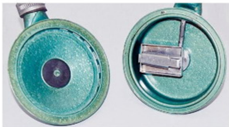
Geöffneter Regler des AV2
