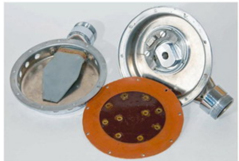
Geöffneter Regler Chirana
