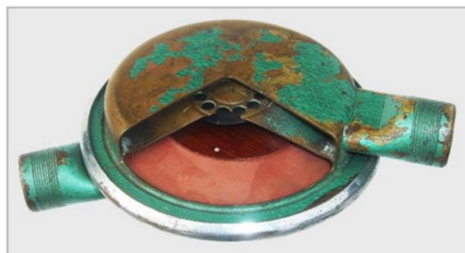
Schnitt durch die Ausatemkammer des AV2
